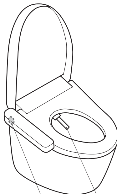
进水过滤装置
