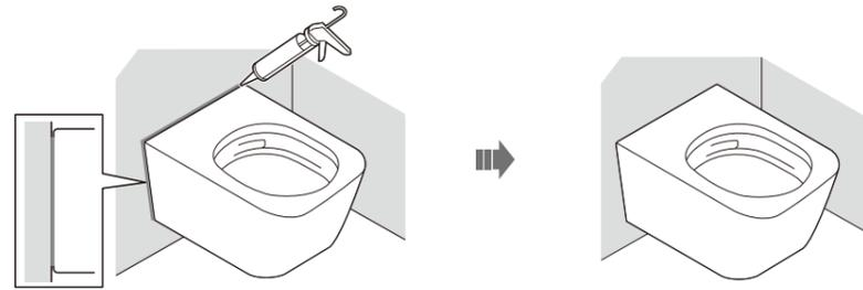
※本产品禁止使用任何水泥安装，对所有因水泥安装引起的坐便器破裂本公司恕不负责。
